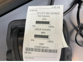
Elektrik donanımı/Pano, Akü > Test Sonucu
