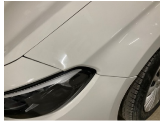
Tampon, ön, Ön tampon > Sabitlemesi Hatalı
