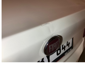
Bagaj kapağı/kapısı, Bagaj kapısı > Ezik
