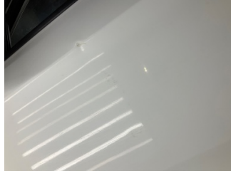
Kapı, sol ön, Kapı, sol ön > Ezik
