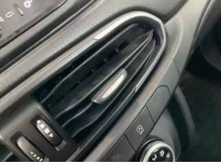
Kalorifer/Klima, Havalandırma izgarası sabitlemesi > Kırılmış
