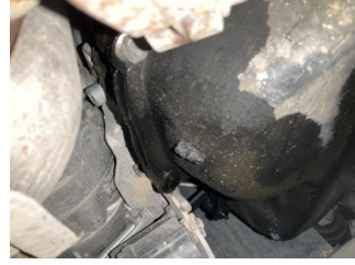
Motor, Motor > Yağ Kaçağı
