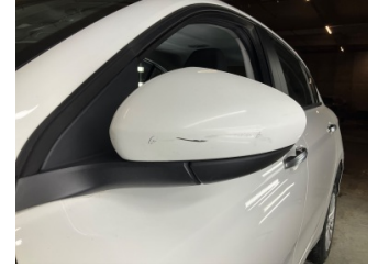
Dikiz aynası, sol, Dış dikiz aynası kapağı > Yüzeysel Çizik
