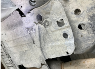
Motor, Alt muhafaza > Hasarlı
