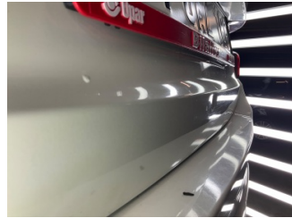
Bagaj kapağı/kapısı, Bagaj kapısı > Vuruk
