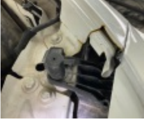
Çamurluk, sol, Bağlantı ayağı > Ezik
