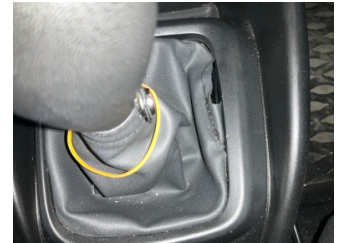
Şanzıman, Vites körüğü > Hasarlı
