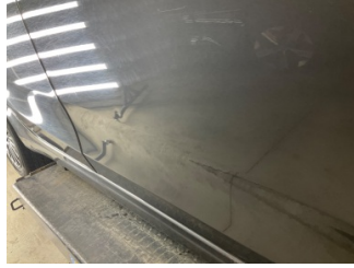
Kapı, sağ ön, Kapı, sağ > Noktasal Ezik
