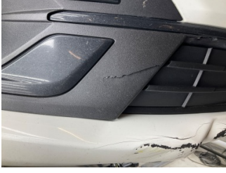
Sis lambaları, Sis Izgarası Sağ > Hasarlı
