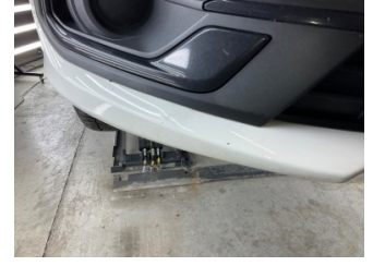
Tampon, ön, Ön tampon > Kırılmış
