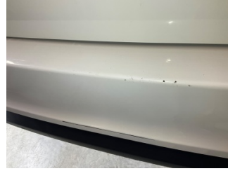
Tampon, arka, Arka tampon > Boyası Atmış
