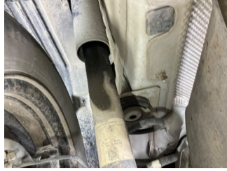
Arka aks, Amortisör, arka sol > Yağ Kaçağı
