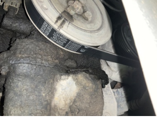
Motor, Motor > Yağ Kaçağı
