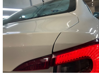
Bagaj kapağı/kapısı, Bagaj kapısı > Sabitlemesi Hatalı
