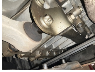
Şanzıman, Şanzıman > Yağ Kaçağı
