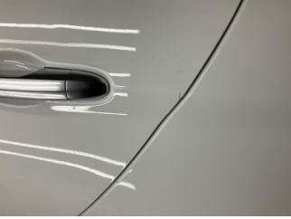
Kapı, sol arka, Kapı, sol arka > Çizik
