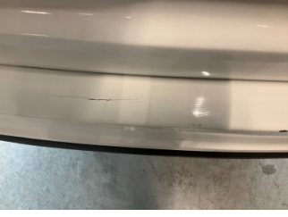
Tampon, arka, Arka tampon > Çatlak
