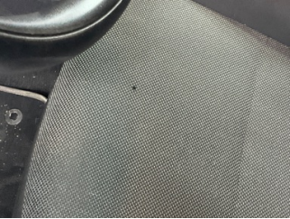
Döşemeler/Kapaklar, Döşemeler/Kapaklar > Yakıcı Madde Ile Zarar Görmüş
