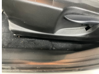
Döşemeler/Kapaklar, Döşemeler/Kapaklar > Yakıcı Madde Ile Zarar Görmüş
