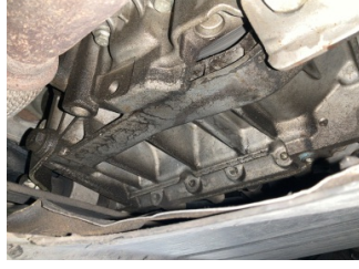
Şanzıman, Şanzıman > Yağ Kaçağı
