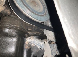
Motor, Motor > Yağ Kaçağı
