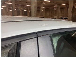
Tavan, Tavan > Dolu Hasarı
