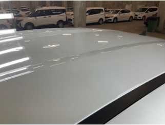
Tavan, Tavan > Dolu Hasarı
