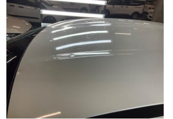
Tavan, Tavan > Dolu Hasarı
