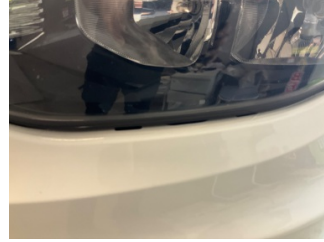
Tampon, ön, Ön tampon > Sabitlemesi Hatalı
