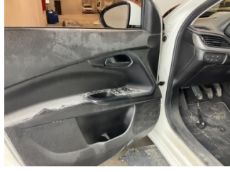
Döşemeler/Kapaklar, Döşemeler/Kapaklar > Deforme Olmuş
