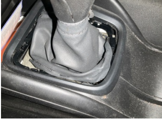
Şanzıman, Vites körüğü > Hasarlı
