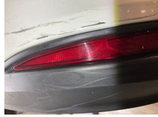
Tampon, arka, Reflektör, sol > Çatlak
