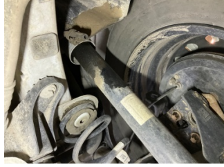
Arka aks, Amortisör, arka sağ > Yağ Kaçağı
