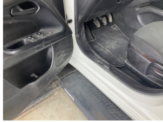
Döşemeler/Kapaklar, Döşemeler/Kapaklar > Çizik
