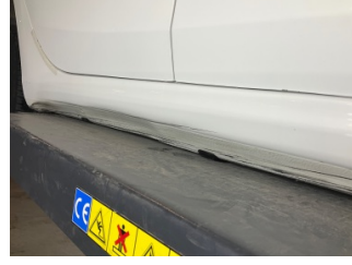
Marşbiyel, sağ, Marşbiyel, sağ > Hasarlı
