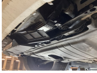
Kaporta, Muhafaza, orta > Hasarlı
