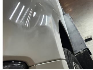
Çamurluk, sol, Çamurluk, sol > Deforme Olmuş
