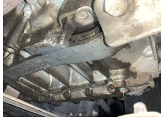
Şanzıman, Şanzıman > Yağ Kaçağı
