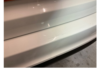
Tampon, arka, Arka tampon > Çatlak
