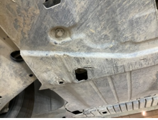
Motor, Alt muhafaza > Hasarlı
