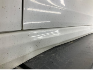
Marşbiyel, sol, Marşbiyel, sol > Hasarlı
