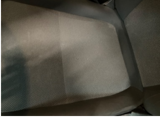
Döşemeler/Kapaklar, Döşemeler/Kapaklar > Yakıcı Madde Ile Zarar Görmüş
