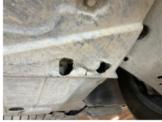
Motor, Alt muhafaza > Hasarlı
