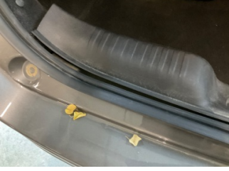
Döşemeler/Kapaklar, Yükleme eşiği kaplaması > Sabitlemesi Hatalı
