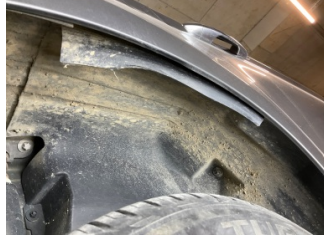
Çamurluk, sağ arka, Davlumbaz > Sabitlemesi Hatalı
