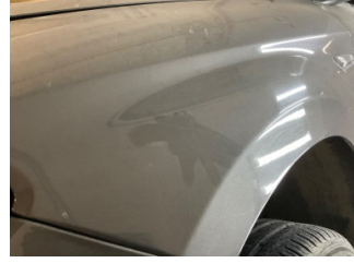
Çamurluk, sol, Çamurluk, sol > Küçük Çizik
