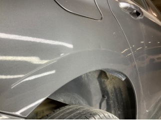
Çamurluk, sağ arka, Çamurluk, sağ arka > Ezik
