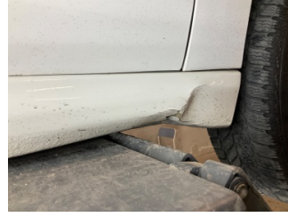
Marşbiyel, sağ, Marşbiyel, sağ > Hasarlı
