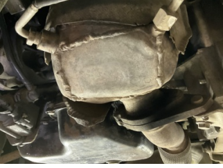
Egzoz sistemi, Partikül filtresi > Standart Dışı Onarım
