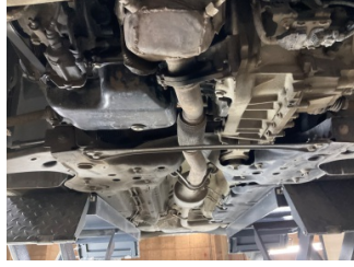
Motor, Alt muhafaza > Sökülmüş-Yok
