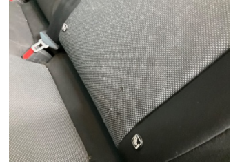
Döşemeler/Kapaklar, Döşemeler/Kapaklar > Yakıcı Madde ile Zarar Görmüş
