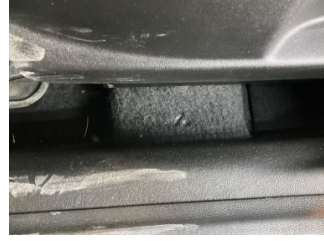
Döşemeler/Kapaklar, Döşemeler/Kapaklar > Yakıcı Madde ile Zarar Görmüş
