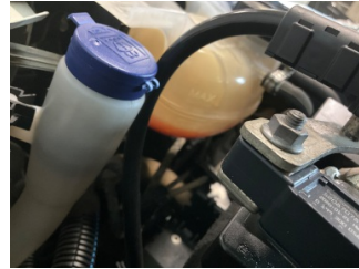
Motorsoğutması, Soğutma sıvısı > Eksik
