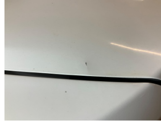
Bagaj kapağı/kapısı, Bagaj kapısı > Noktasal Ezik
