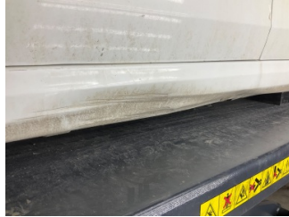
Marşbiyel, sol, Marşbiyel, sol > Hasarlı
