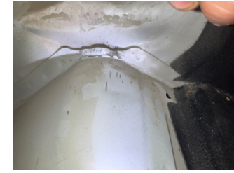
Arka bölüm, Bagaj havuzu > Hasarlı
