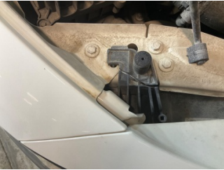
Farlar, Far bağlantı ayağı, sağ > Hasarlı
