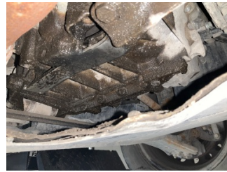
Şanzıman, Şanzıman > Yağ Kaçağı
