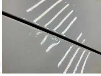
Çamurluk, sağ arka, Çamurluk, sağ arka > Ezik
