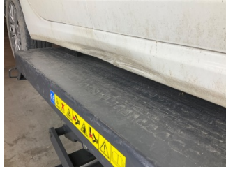
Marşbiyel, sağ, Marşbiyel, sağ > Hasarlı
