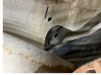
Arka bölüm, Arka sac/panel > Hasarlı
