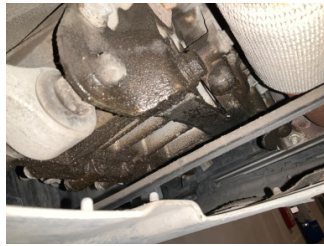
Şanzıman, Şanzıman > Yağ Kaçağı
