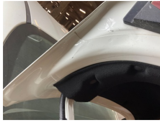
Komünikasyon/Navigasyon/EğlenceBagaj kapağı/kapısı, Bagaj sistemleri, Anten > Sökülmüş-Yok kapısı > Hasarlı
