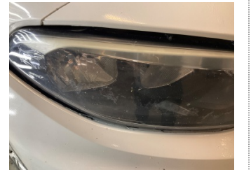
Farlar, Far camı, sağ > Deforme Olmuş
