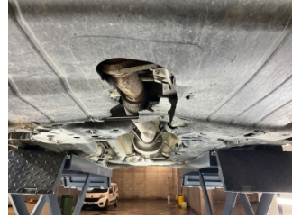
Motor, Alt muhafaza > Hasarlı
