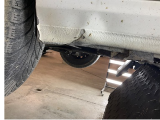
Marşbiyel, sol, Marşbiyel, sol > Hasarlı
