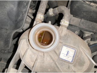
Motorsoğutması, Soğutma sıvısı > Kirlenmiş
