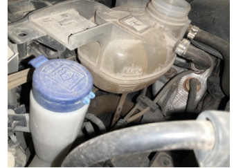
Motorsoğutması, Soğutma sıvısı > Eksik
