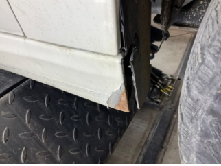
Marşbiyel, sağ, Marşbiyel, sağ > Boyası Atmış
