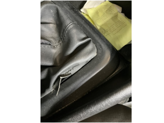
Şanzıman, Vites körüğü > Hasarlı
