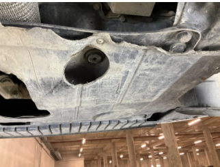
Motor, Alt muhafaza > Hasarlı
