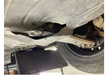
Motor, Alt muhafaza > Hasarlı
