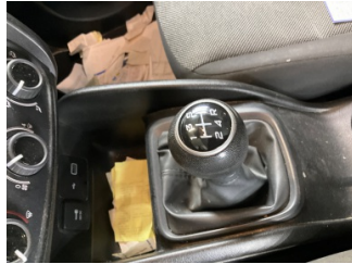
Şanzıman, Vites topuzu > Deforme Olmuş
