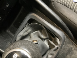
Şanzıman, Vites körüğü > Hasarlı
