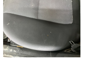
Döşemeler/Kapaklar, Döşemeler/Kapaklar > Yakıcı Madde Ile Zarar Görmüş
