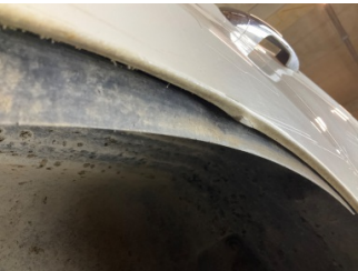
Çamurluk, sağ arka, Davlumbaz > Sabitlemesi Hatalı
