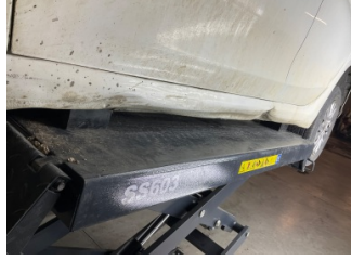
Marşbiyel, sol, Marşbiyel, sol > Hasarlı
