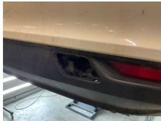
Tampon, arka, Çeki demir kapağı > Sökülmüş-Yok
