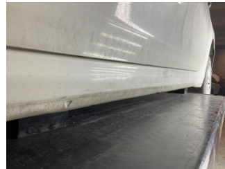
Marşbiyel, sol, Marşbiyel, sol > Hasarlı
