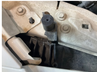
Farlar, Far bağlantı ayağı, sağ > Hasarlı
