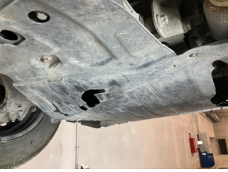
Motor, Alt muhafaza > Hasarlı
