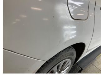
Çamurluk, sağ arka, Çamurluk, sağ arka > Ezik
