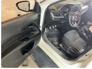
Döşemeler/Kapaklar, Döşemeler/Kapaklar > Deforme Olmuş
