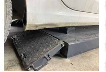
Marşbiyel, sağ, Marşbiyel, sağ > Hasarlı
