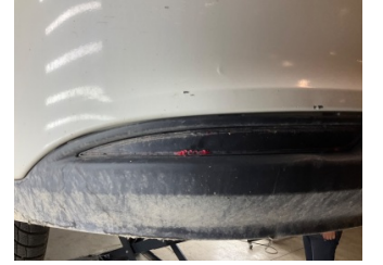
Tampon, arka, Reflektör, sol > Hasarlı
