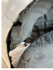
Çamurluk, sağ arka, Davlumbaz > Hasarlı
