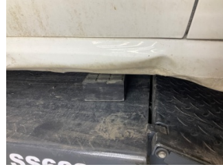
Marşbiyel, sağ, Marşbiyel, sağ > Hasarlı
