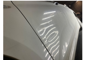
Kapı, sol ön, Kapı, sol ön > Hasarlı
