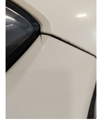
Tampon, ön, Ön tampon > Kırılmış
