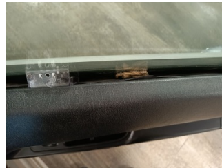
Kapı, sağ ön, Cam mekanizması > Arızalı
