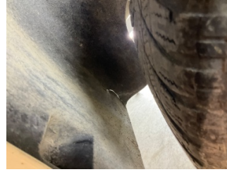
Çamurluk, sağ arka, Davlumbaz > Hasarlı
