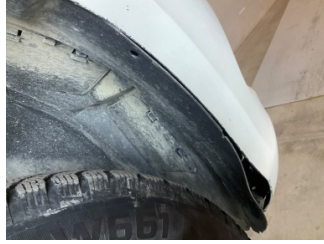
Çamurluk, sağ, Davlumbaz > Sabitlemesi Hatalı
