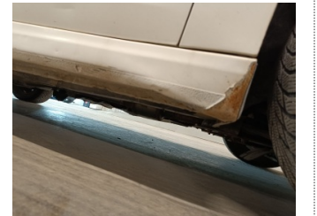
Marşbiyel, sağ, Marşbiyel, sağ > Hasarlı
