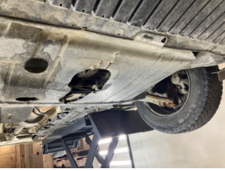
Motor, Alt muhafaza > Hasarlı
