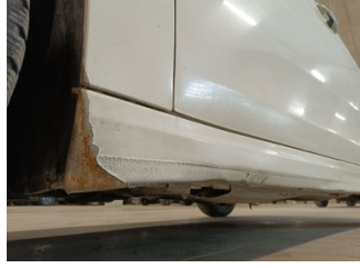
Marşbiyel, sol, Marşbiyel, sol > Hasarlı
