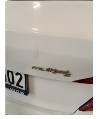
Bagaj kapağı/kapısı, Bagaj kapısı > Ezik
