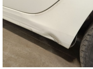
Marşbiyel, sol, Marşbiyel, sol > Hasarlı
