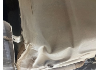
Arka bölüm, Bagaj havuzu > Hasarlı
