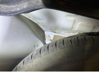
Arka bölüm, Bagaj havuzu > Hasarlı
