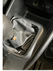
Şanzıman, Vites körüğü > Hasarlı
