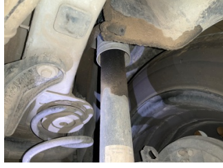
Arka aks, Amortisör, arka > Yağ Kaçağı
