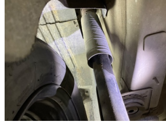
Arka aks, Amortisör, arka > Yağ Kaçağı
