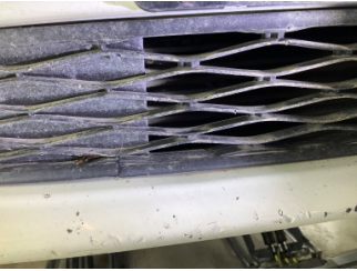
Tampon, ön, Ön tampon ızgarası > Hasarlı
