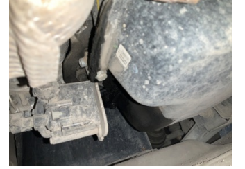
Motor, Motor > Yağ Kaçağı
