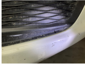
Sis lambaları, Sis ızgarası Sağ > Hasarlı
