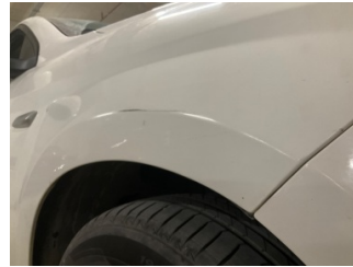
Çamurluk, sağ, Çamurluk, sağ > Ezik
