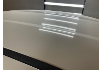
Tavan, Tavan > Dolu Hasarı
