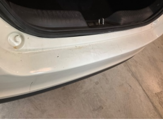
Tampon, arka, Arka tampon > Çatlak
