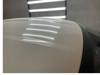
Tavan, Tavan > Dolu Hasarı
