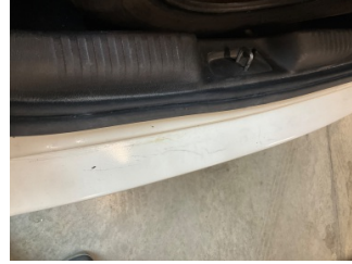
Döşemeler/Kapaklar, Döşemeler/Kapaklar > Çizik
