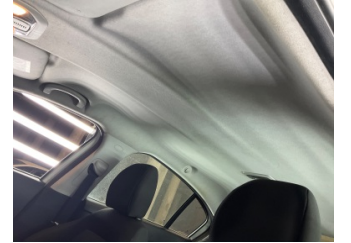
Döşemeler/Kapaklar, Döşemeler/Kapaklar > Deforme Olmuş
