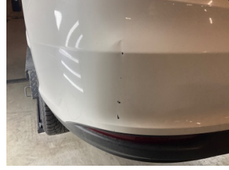
Tampon, arka, Bağlantı ayağı > Çatlak
