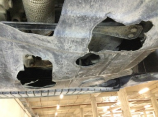
Motor, Alt muhafaza > Hasarlı
