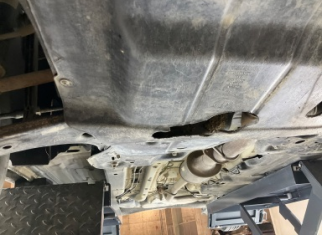
Motor, Alt muhafaza > Hasarlı
