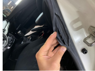
Kapı, sol ön, Kapı fitili > Hasarlı
