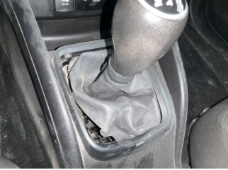
Şanzıman, Vites körüğü > Hasarlı
