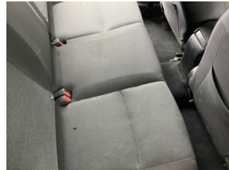
Döşemeler/Kapaklar, Döşemeler/Kapaklar > Yakıcı Madde ile Zarar Görmüş
