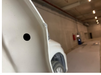
Kapı, sağ ön, Kapı, sağ > Boyası Atmış
