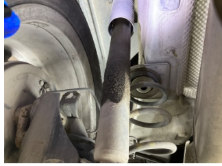
Arka aks, Amortisör, arka > Yağ Kaçağı
