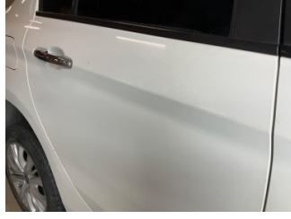
Kapı, sağ arka, Kapı, sağ arka > Ezik
