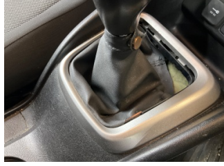
Şanzıman, Vites körüğü > Hasarlı
