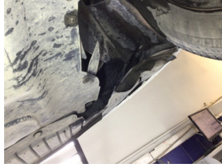
Motor, Alt muhafaza > Hasarlı
