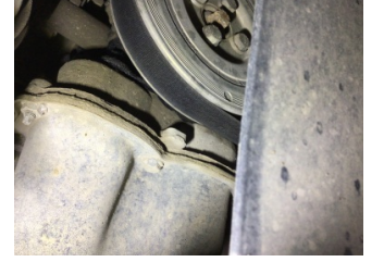
Motor, Triger zinciri kapağı > Yağ Kaçağı
