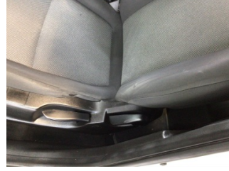
Koltuklar, ön, Koltuk, sol ön > Deforme Olmuş
