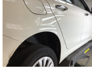
Çamurluk, sağ arka, Çamurluk, sağ arka > Ezik
