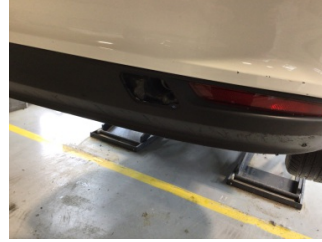
Tampon, arka, Çeki demir kapağı > Sökülmüş-Yok
