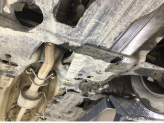
Motor, Alt muhafaza > Hasarlı
