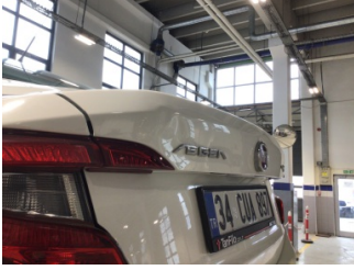
Bagaj kapağı/kapısı, Bagaj kapısı > Ezik
