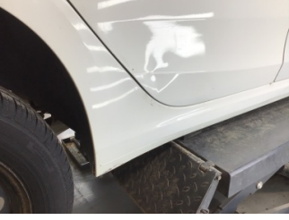
Kapı, sağ arka, Kapı, sağ arka > Ezik
