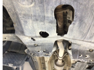
Motor, Alt muhafaza > Hasarlı
