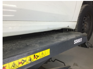
Marşbiyel, sağ, Marşbiyel, sağ > Hasarlı
