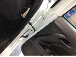
Kapı, sağ arka, Kapı gergisi > Ses Yapıyor
