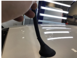
Komünikasyon/Navigasyon/EğlenceKapı, sağ ön, Kapı fitili > Hasarlı sistemleri, Anten > Deforme Olmuş
