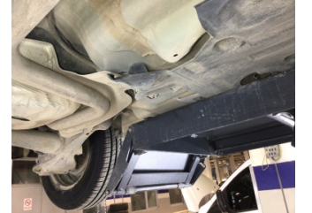
Motor, Alt muhafaza > Hasarlı
