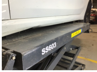
Marşbiyel, sol, Marşbiyel, sol > Hasarlı
