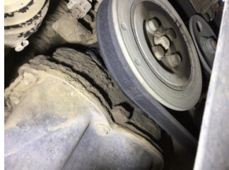
Motor, Triger zinciri > Yağ Kaçağı
