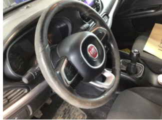
Direksiyon sistemi, Direksiyon simidi > Deforme Olmuş
