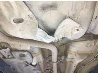
Motor, Alt muhafaza > Hasarlı
