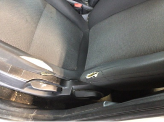
Koltuklar, ön, Koltuk, sol ön > Deforme Olmuş
