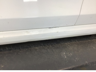
Marşbiyel, sol, Marşbiyel, sol > Standart Dışı Onarım
