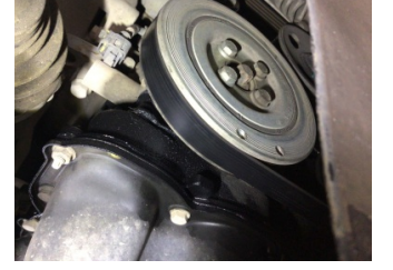
Motor, Triger zinciri kapağı > Yağ Kaçağı
