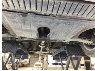
Motor, Alt muhafaza > Hasarlı
