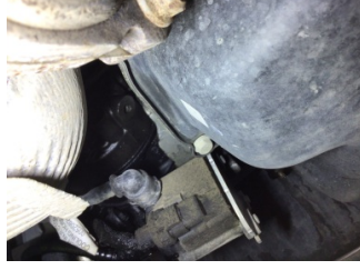
Motor, Yağ filtresi > Yağ Kaçağı
