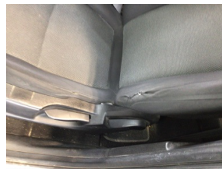
Koltuklar, ön, Koltuk, sol ön > Deforme Olmuş
