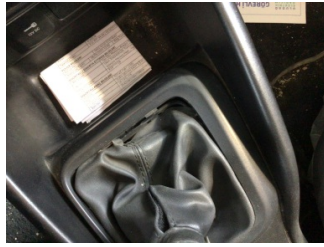
Şanzıman, Vites körüğü > Deforme Olmuş
