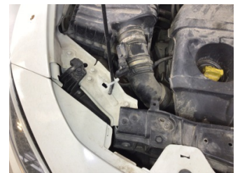
Motor kaputu, Dayama çubuğu/Amortisör > Kırılmış
