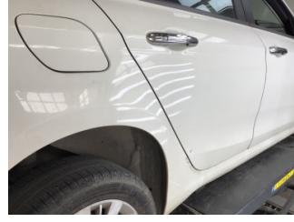
Çamurluk, sağ arka, Çamurluk, sağ arka > Ezik
