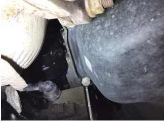
Motor, Triger zinciri kapağı > Yağ Kaçağı
