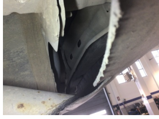
Arka bölüm, Römork çeki demiri > Hasarlı
