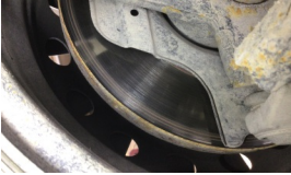
Fren disk, sağ ön > Aşınmış
