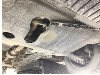
Motor, Alt muhafaza > Hasarlı
