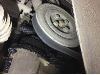
Motor, Triger zinciri kapağı > Yağ Kaçağı
