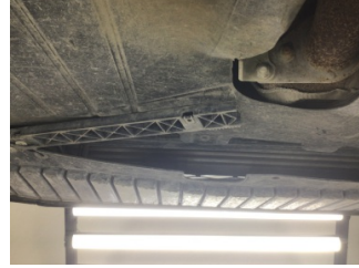
Motor, Alt muhafaza > Hasarlı
