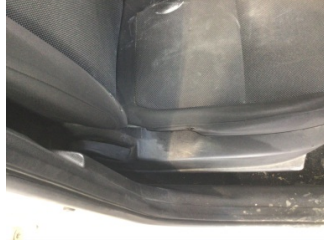
Koltuklar, ön, Koltuk, sağ ön > Deforme Olmuş
