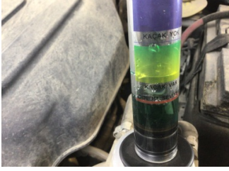
Motor, Silindir kapağı contası > Test Sonucu
